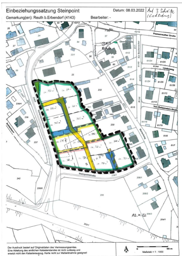
Abb.: Erschließungsvarianten mit durchgehender Erschließung und zwei Erschließungsstichen mit je 12 m breiten Wendehämmern, eigene Darstellung
